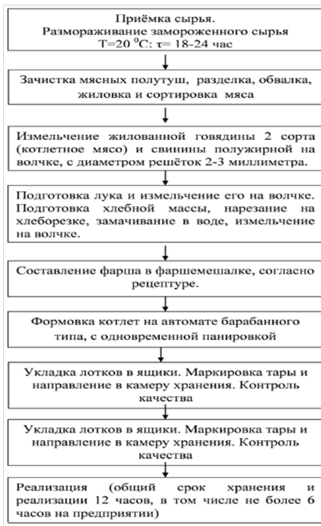
Рисунок – 1. Технологическая схема производства рубленых полуфабрикатов (котлет)
